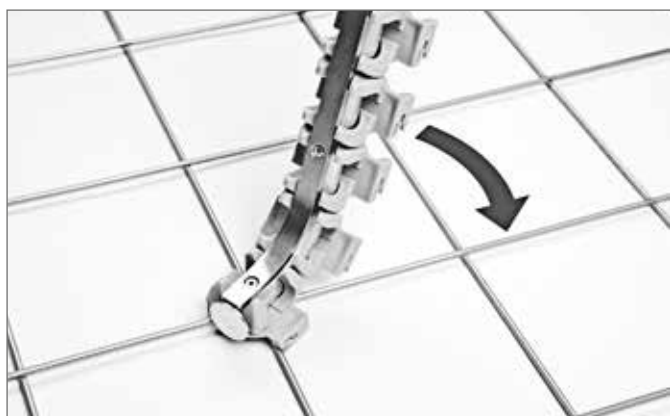
Рис. 15-62 Закрепить поворотную клипсу вращательным движением
